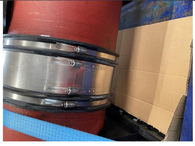
No leak after the second hydraulic test/ Pas de fuite après le 2<sup>ème</sup> test hydraulique
