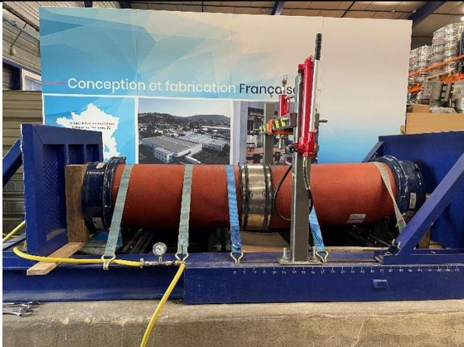
Flex Seal Plus SC 445 pendant le premier test hydraulique avec un angle de 2.3°/ Flex Seal Plus SC 445\_during the first test with angle deviation of 2.3°
