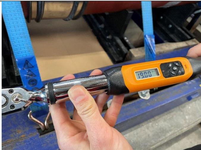
Une clé dynamométrique pour serrer le Flex Seal Plus SC 445 à 19 Nm / torque wrench to clamp the Flex Seal Plus SC 445
