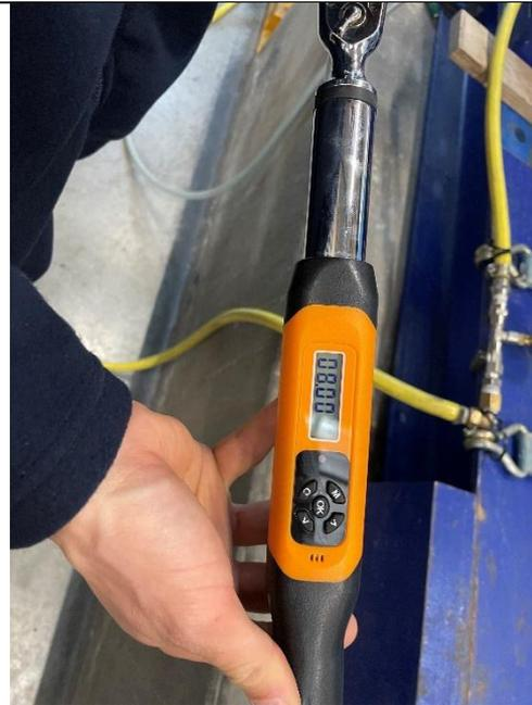
Serrage de Flex Seal Plus SC 175 avant le lancement du premier test / Tightening of the Flex Seal Plus SC 175 before the fist hydraulic test
