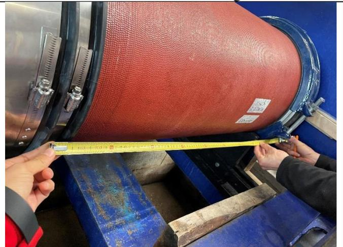
Mesure des distances entre les appuis pour calculer la charge de cisaillement à appliquer pendant le 2<sup>ème</sup> test hydraulique/ Preparing the second test by measuring distances to apply the shear load
