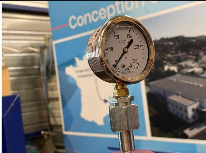
Manomètre à aiguille/ Needle pressure gauge HPC40
