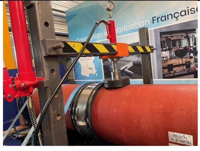
Mesure des distances entre les appuis pour calculer la charge de cisailment à appliquer pendant le 2<sup>ème</sup> test hydraulique/ Preparing the second test by mesuring distances to apply the shear load
