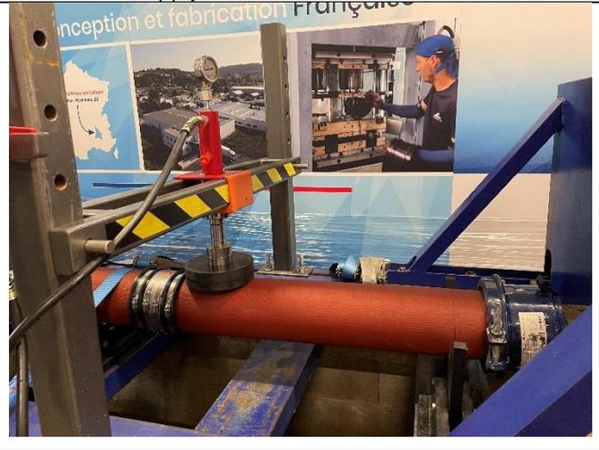
Préparation de deuxième test hydraulique sur le Flex Seal Plus SC 175 pour appliquer la charge de cisaillement/ Preparing the second test on the Flex Seal Plus SC 175 to apply the shear load
