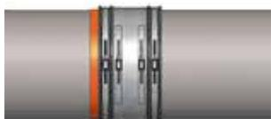
4. Faire glisser le raccord jusqu'au repère tracé et serrer toutes les fixations jusqu'au blocage (le couple de serrage recommandé est indiqué sur l'étiquette du raccord).
