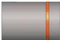
1. Tracer sur le tuyau de plus grand diamètre extérieur un repère correspondant à la moitié de la largeur du raccord.
