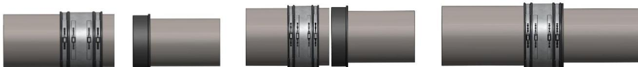
① Desserrer les fixations et faire glisser le raccord sur le tube de plus grand diamètre extérieur
