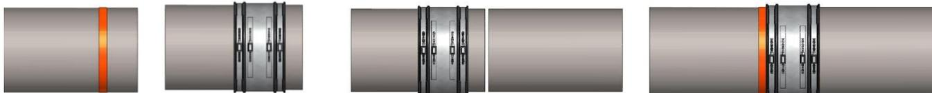
① Tracer sur le tuyau de plus grand diamètre extérieur un repère correspondant à la moitié de la largeur du raccord
