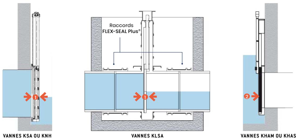
① Étanchéité<sup>(1)</sup> bidirectionnelle, à l'arrachement et à la poussée. // ② Étanchéité<sup>(1)</sup> unidirectionnelle à la poussée.
