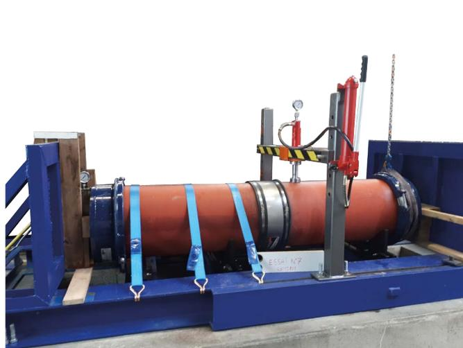
Tests réalisés sur raccord FLEX-SEAL Plus® SC175 et SC445.
