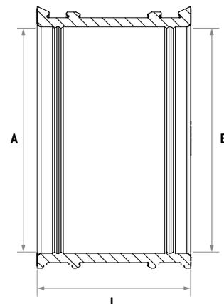
(1) Pression de service : 0,6 bar ; pression d'essai : 0,6 bar.
