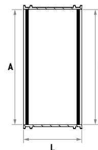
(1) Voir « Qu'est ce que le Δ max. ? » en p. 9. // (2) Pression de service : 1,0 bar ; pression d'essai : jusqu'à 1,0 bar (nous consulter) // (3) Pour des montages sur tuyaux flexibles (type PEHD annelés, par exemple) le couple de serrage peut être augmenté. Tenir compte des précautions de montage définies dans la Fiche d'Instructions de Pose fournie avec le raccord (nous consulter).
