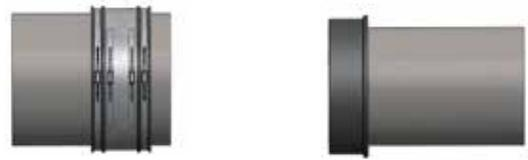
1. Desserrer les fixations et glisser le raccord sur le tube de plus grand diamètre extérieur.
