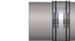
1. Tracer sur le tuyau de plus grand diamètre extérieur un repère correspondant à la moitié de la largeur du raccord.
